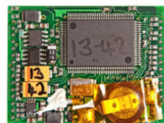
Module fournissant le signal GPS (autre côté)
