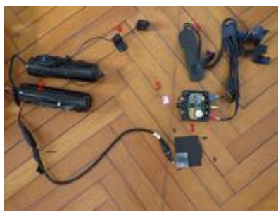
1: unité de contrôle ; 2: batteries ; 3: antenne GPS ; 4: microphone ; 5: carte SIM
