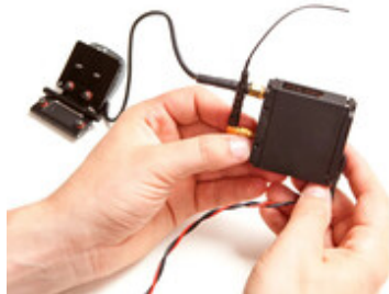
Module d'émission-réception (fermé)
